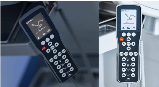
10. Mando manual con pantalla TFT iluminada para visualizar todas las informaciones de estado
